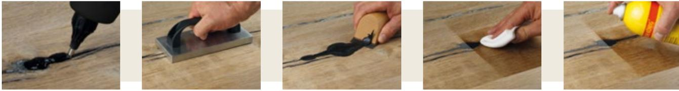
**Anwendungsbeispiel:** Den IF-139 PLUS direkt in die zu befüllende Stelle einbringen und ausreichend überfüllen. Nach dem Befüllen den Füller mit dem Kühlblock abkühlen und mit Druck verdichten. Nach kurzer Abkühlphase den Kühlblock wieder entfernen. Den Überschuss mit dem Handhobel plan abschneiden. Kleinstbefüllungen oder feine Überstände können auch mit Schleifpapier bearbeitet werden. Nun ist die Weiterbearbeitung möglich (z. B. Ölen, Lackieren, Beizen).
